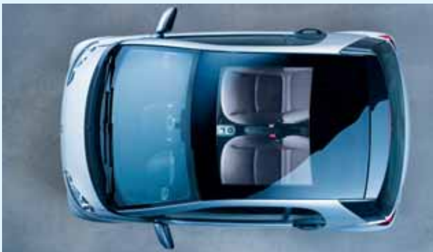
Durchblick mit Makrolon®: Der Markt für Automobilscheiben aus Polycarbonat, z. B. Makrolon®, hat gute Wachstumschancen.
