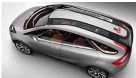
Beste Aussichten: Das Konzeptfahrzeug i-mode besteht von der Frontscheibe über das Dachmodul bis zur Heckscheibe aus Makrolon®-gefertigten Scheibenelementen.
